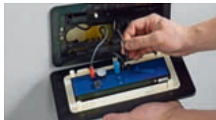
3 Įtampos šaltinis sujungiamas su valdymo nuspaudimo mygtuko užpakalinėje pusėje. Kabeliai sudedami į kreipiamąją. Pasirinktinai galima naudoti baterijų dėtuve.
